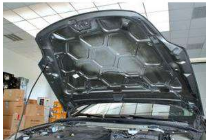
Şekil 3. Kaput izolasyon bölgesi
