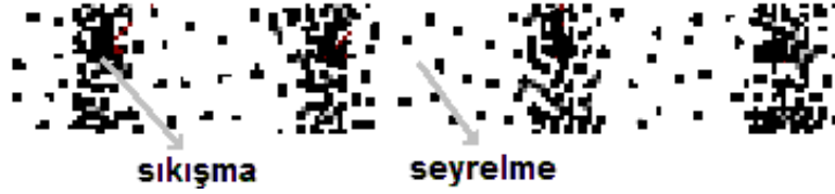
Şekil 1. Ortamı oluşturan parçacıkların geçici sıkışma ve seyrelmesi
