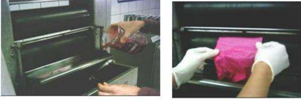
Şekil 3. Fular ve sıkma silindirlerinden kumaş geçirme (internet erişimi 2).
