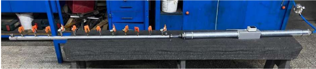
Şekil 1.7. İnsörtlerin değişimi ve ölçümü için kullanılan aparat
