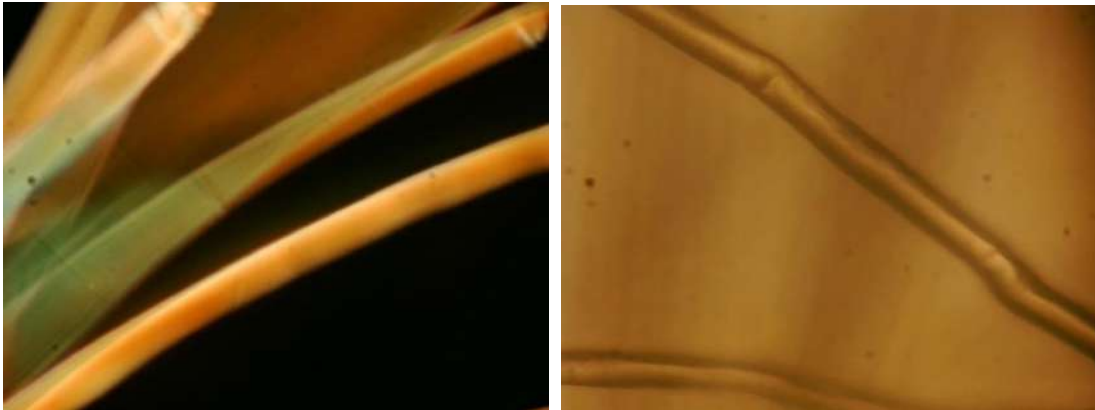
Şekil 4. Normal Liyosel elyafın optik mikroskoptaki boyuna kesit görüntüleri (X60)
