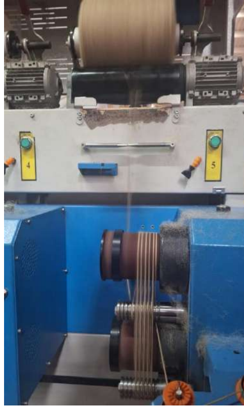
Őekil 1. BCF ipliklerin tiftitilerek tylendirilmesi
