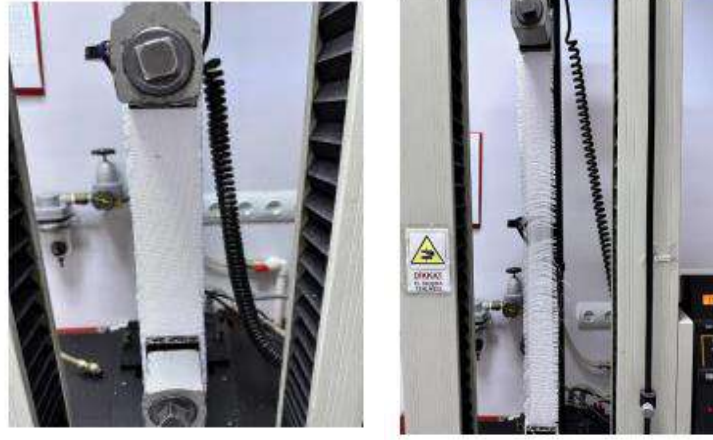
Şekil 3. Numune kopma mukavemeti testi başlangıç ve bitiş görüntüsü
