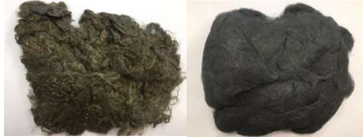
Şekil 1. Gümüş elyafı (a) ve gümüş kaplı poliamid 6,6 elyafı (b)
