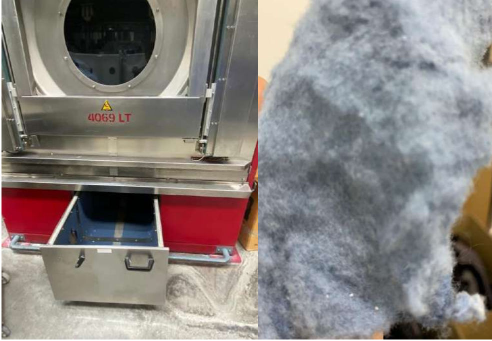
Şekil 1. Tamburlu Kurutma Makinası Döküntü Haznesi ve Biriken Döküntü Elyaf
