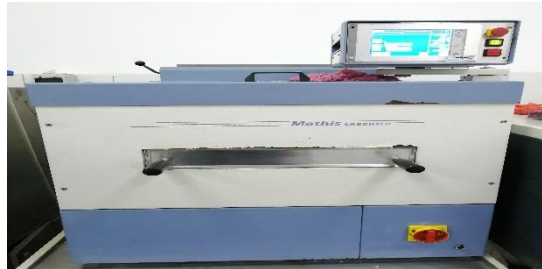
Resim 3. Kurutma Makinesi ( MATHİS LABDRYER )
