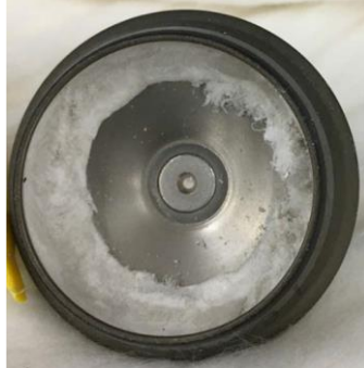
Şekil 3. Rotor yivinde lif birikimi
