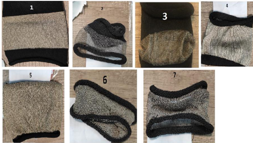
Şekil 5. 7 Farklı İletken İplik ile Üretilen Deneme Kumaş Konstrüksiyonları
