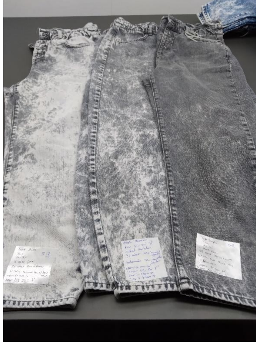
Şekil 3. Sıkma devri farkının ağartma efektine etkisi
