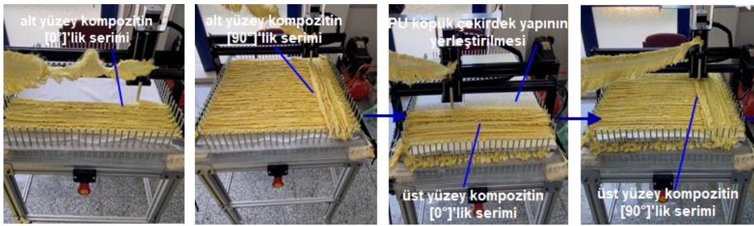
Şekil 3. Sandviç kompozit preformunun üretim aşamaları.
