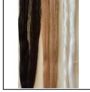
Şekil 5. Laboratuvar boyama makinesinde boyanan PES ve rPET ipliklerin boyama sonu ve boyama öncesi iplik görüntüleri
