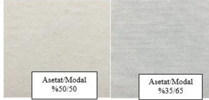
Şekil 2. %50/50 Asetat/Modal ve %35/65 Asetat/Modal Kumaşların Boncuklanma Testi Sonrasına Ait Kumaş Görünümleri
