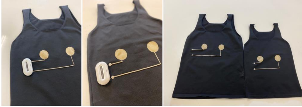
Şekil 8. EKG Cihazı Entegreli Nihai T-Shirt Tasarımı
