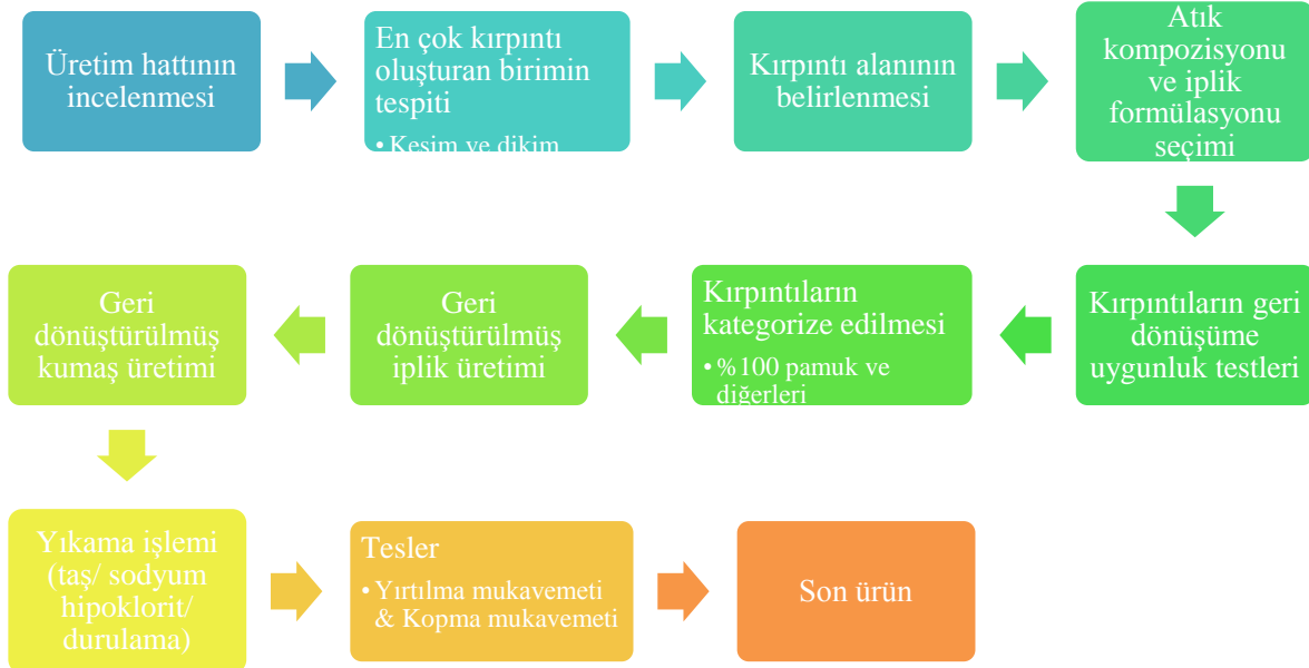
Şekil 5: Kırpıntı kumaşların son ürüne dönüşüm adımları
