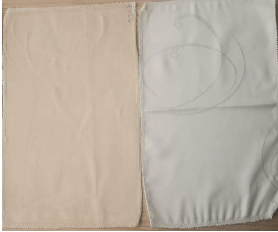
Şekil-1. Sepiyolit ile kaplanmış (a) ve kaplama yapılmamış (b) polyester esaslı kumaşlar
