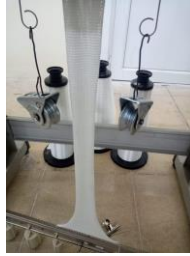
Şekil 1. Atkılı düz örme makinesinde tüp formunda cam iplik kumaş üretilirken çekilmiş fotoğraf
