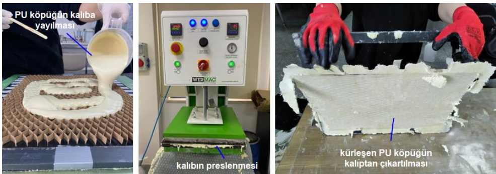
Şekil 2. Çekirdek yapıların üretim aşamaları.
