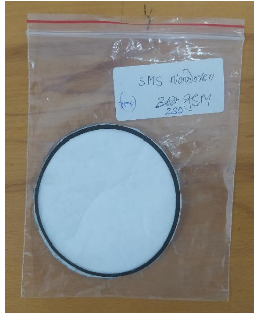
Şekil1. 230 g/m 2 SMS dokusuz yüzey
