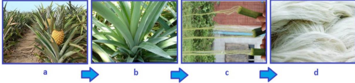
Şekil 2. Ananas yaprağı liflerinin üretimi sırasıyla; (a) meyve vermiş ananas bitkisi, (b) ananas bitkisi yaprakları, (c) ananas yaprakları içerisinde bulunan lifler ve (d) ananas yaprağı lifleri [11]
