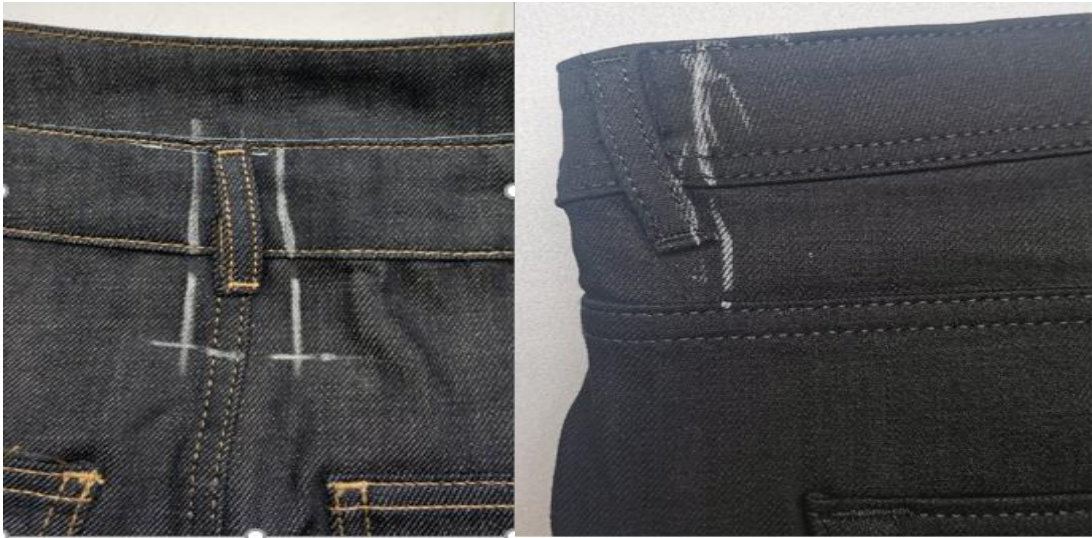
Şekil 5. Manuel Dikilen Kemeraltı Köprü Hata Örnekleri
