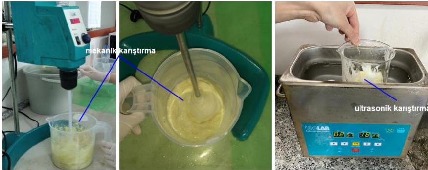
Şekil 1. Polyol/kırpıntı Kevlar® karıştırma işlemi.
