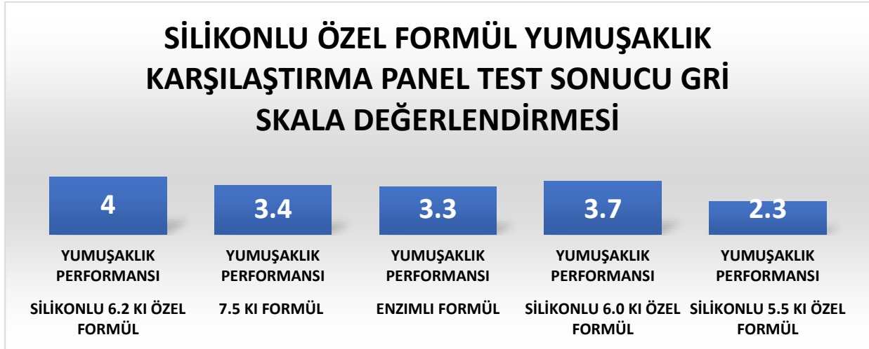
Şekil 7. Silikonlu Özel Formül Yumuşaklık Karşılaştırması Gri Skala Değerlendirmesi
